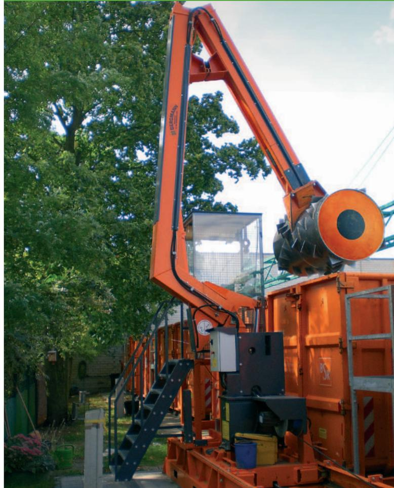
**Die BERGMANN RPV 7700 Verschiebeanlage für mehrere parallel stehende Container an einem Standort.**
