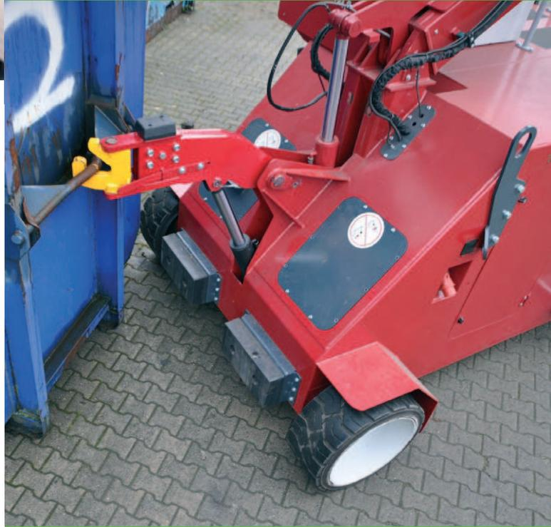
**Der BERGMANN Roll-Packer RPM 7700 Jumbo für den mobilen Einsatz an beliebigen Plätzen eines Standortes.** Der Mobil Jumbo® ist stark, wendig und verfügt zusätzlich über eine Containerverfahreinrichtung.
